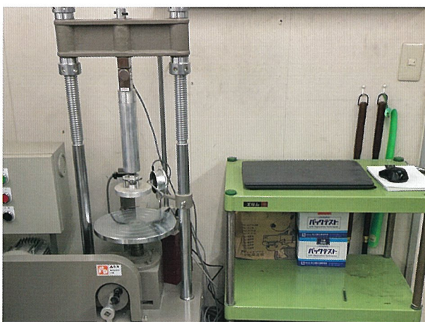
品質試験室（一軸圧縮試験機）
